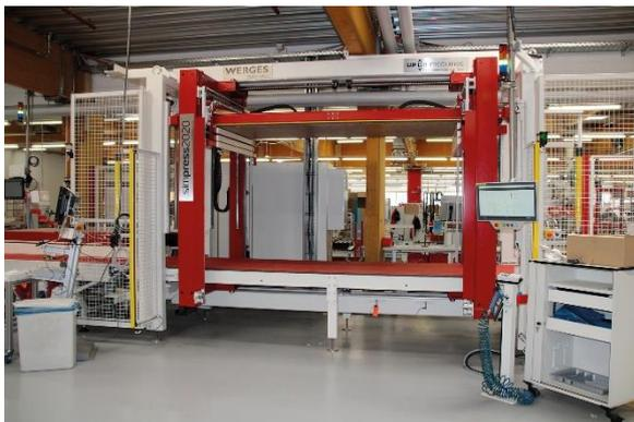
Mit der automatischen Durchlaufkorpuspresse SIMPRESS 2020 hat ASSMANN im Frühjahr 2020 seine Fertigungskapazitäten in der Schrankproduktion verdoppelt.
