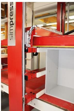
Synchron laufende Servomotoren sorgen bei der SIMPRESS 2020 für ein geräuscharmes, energieeffizientes Verpressen der Schränke mit bis zu drei Tonnen Druckkraft. © up in machines GmbH
